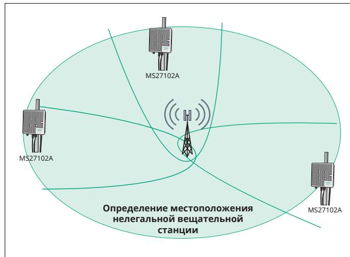
Рис. 12: Использование технологии TDOA для установки местоположения источника помехи
